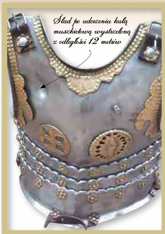
Replika napierśnika husarskiego, testowana kulą muszkietową wystrzeloną z odległości 12 metrów. Grubość napierśnika 2 mm. Fot. kmdr ppor. Paweł Michowski
