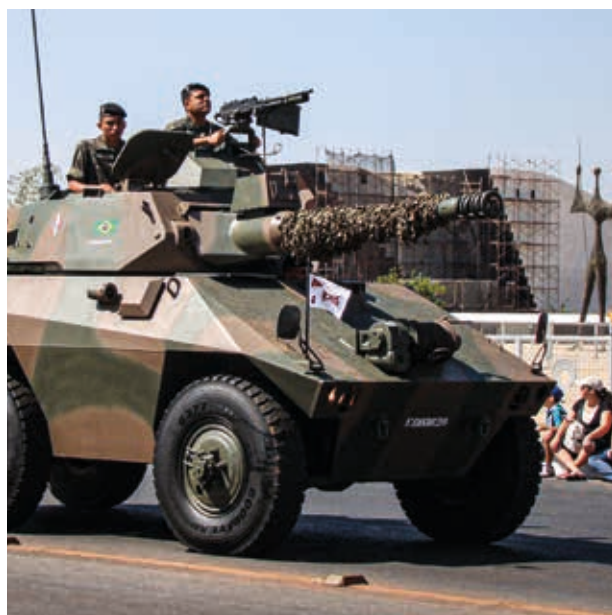
Najczęściej uzbrojone w arsenale Kolumbii są kołowe pojazdy rozpoznawcze produkcji brazylijskiej EE-9 Cascavel z 90-milimetrową armatą.
