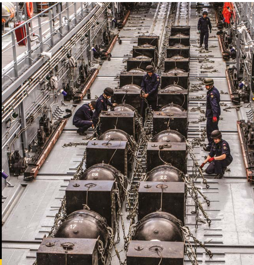
Okręty typu Lublin zabierają na pokład od 50 do 80 min, które umieszczane są w specjalnych torach do ich przechowywania i zrzutu.
