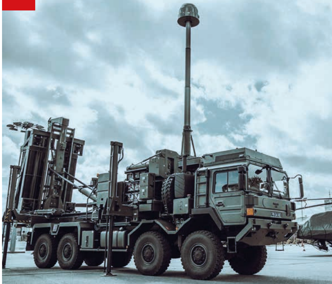
Brytyjski Sky Sabre to system średniego zasięgu, wykorzystujący nowoczesne rakiety z rodziny CAMM (Common Anti-Air Modular Missile), które znajdują się też w systemie Narew.
