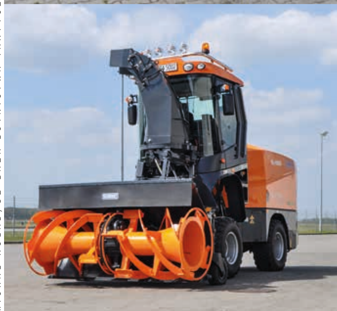
Dzięki rotorowi SUPRA 5002 żołnierze KOL-u są w stanie usunąć bardzo duże ilości śniegu z drogi startowej.
