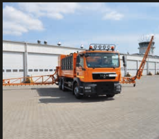
Polewaczka ORION PP2 rozpyla specjalną substancję chemiczną, która rozpuszcza lód.
