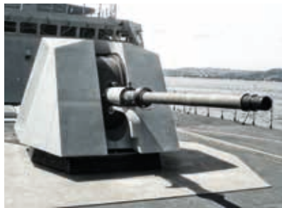
Uzbrojenie, zarządzane przez zintegrowany system walki Tacticsos, będzie się składać z jednej armaty OTO Melara kalibru 76 mm Super Rapido (na zdjęciu), maksymalnie dwóch 35-milimetrowych armat OSU-35, lekkich torped MU-90, pocisków przeciwokrętowych RBS-15 Mk3 oraz rakiet przeciwlotniczych CAMM i CAMM-ER.
