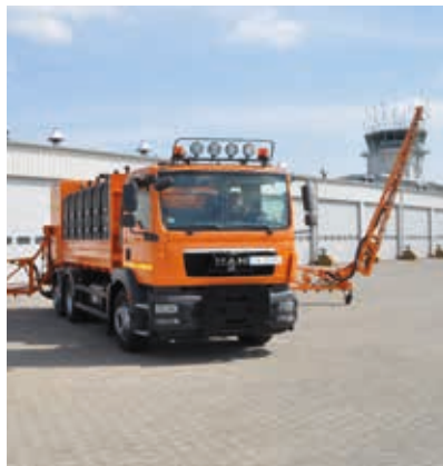
Na pole manewrowe wyjeżdżają oczyszczarki i odkurzacze lotniskowe, a następnie pojazd z magnesnicą, która przyciąga stalowe elementy.
