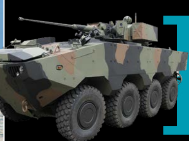
BAE Systems opracowało ACV oparty na konstrukcji kołowego transportera opancerzonego SuperAV 8x8 włoskiej firmy Iveco Defence Vehicles.
