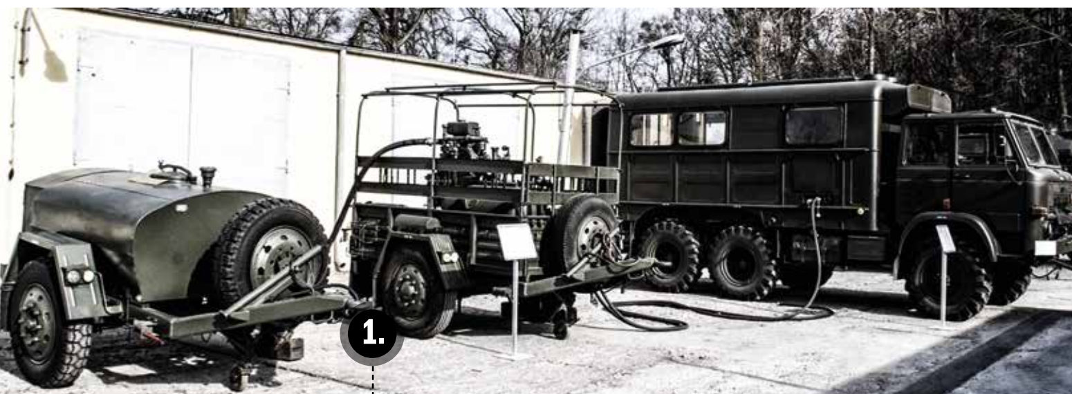
Urządzenie grzejne typu UG-88 na przyczepie jednoosiowej 1,5 t oraz samochód-łaźnia polowa typu SŁP-117N na podwoziu samochodu Star 266. Aby zapewnić usługi kąpielowe, urządzenia te należy zestawzić ze sobą i utworzyć tzw. sekcję kąpielową.
