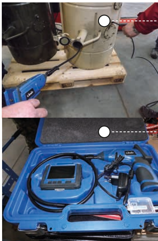
Fot. 7. Wprowadzenie sondy endoskopu
