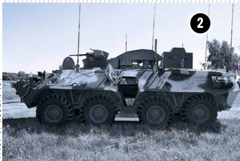
Tajfun-M – zwraca uwagę (patrzac od lewej) zdalnie sterowane stanowisko strzeleckie
