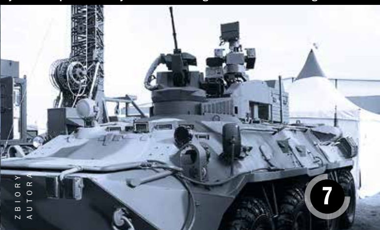
BPDM Tajfun-M z podniesionym masztem kompleksu rozpoznawczego
