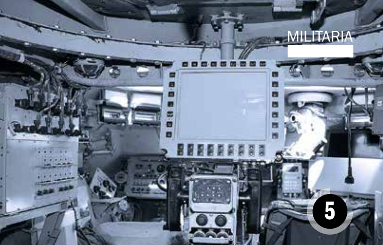
Wyświetlacz i panel kontrolny zdalnie sterowanego stanowiska strzeleckiego
