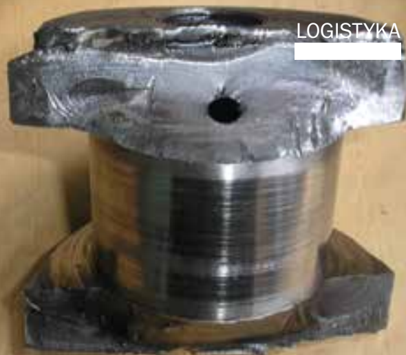
Przełom części uszkodzonego wału korbowego
