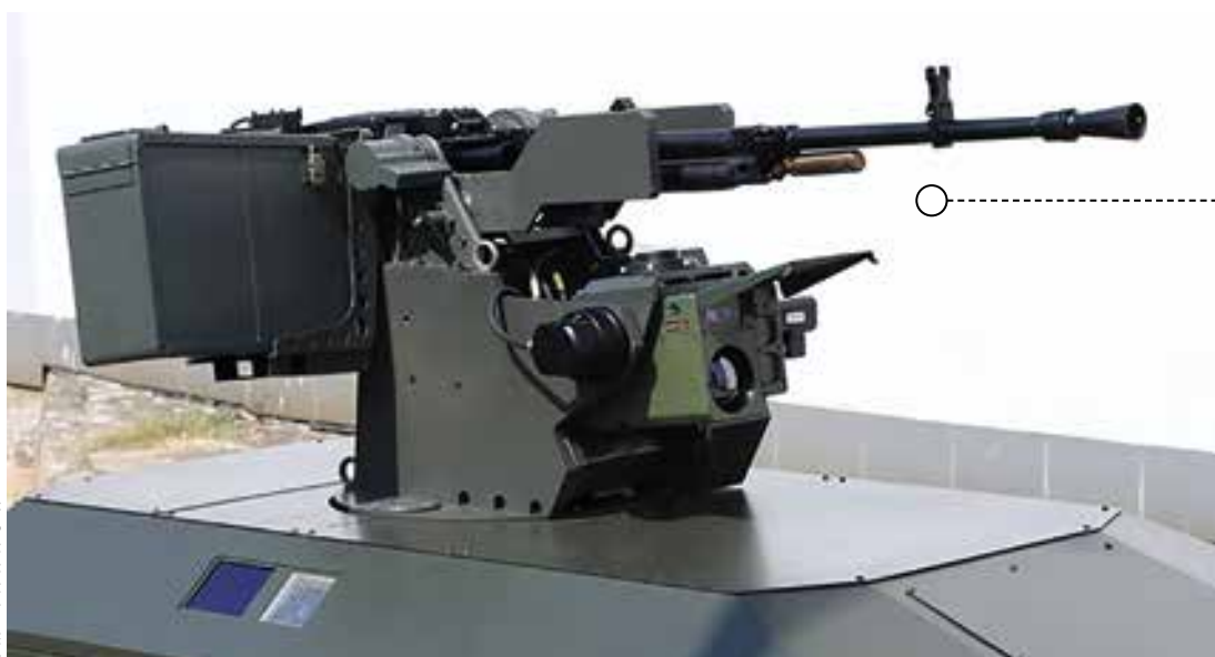
Zdalnie sterowany moduł uzbrojenia ZSMU A3C: – karabin maszynowy kalibru 7,62 mm oraz opcjonalnie wielkokali- browy karabin maszy- nowy kalibru 12,7 mm; – ilość amunicji dostę- pna do użycia: kalibru 7,62 mm – 500 szt., kalibru 12,7 mm – 100 szt.
