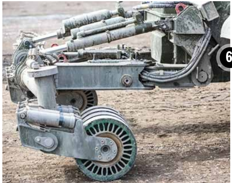
Trał naciskowy z kołami z tworzywa sztucznego oraz z hydraulicznym układem zawieszenia – Self Protection Combat Roller
