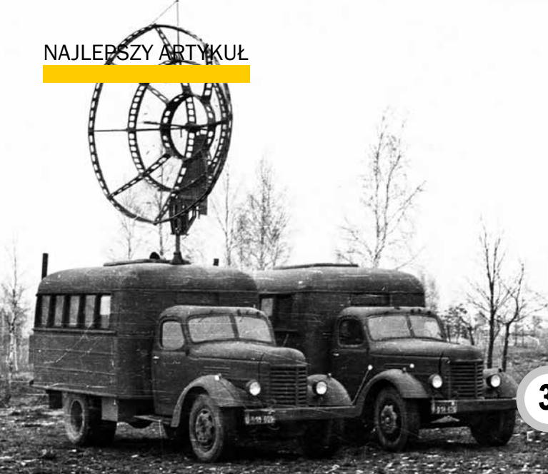
Odległościomierz Nysa-A (z lewej) oraz wysokościomierz Nysa-B (z prawej)
