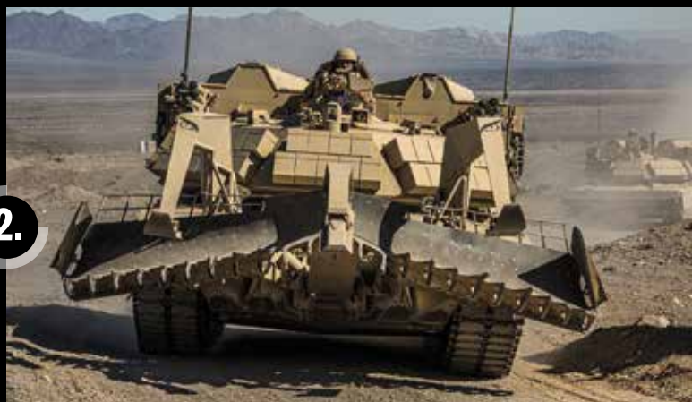
M1 Assault Breacher Vehicle z trałem wykopowym o szerokości trałowania 4,5 m
