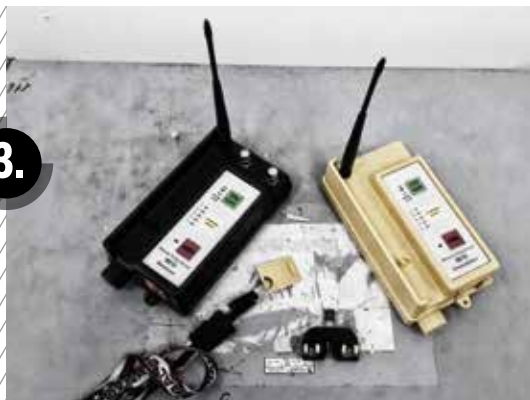
System radiowego sterowania wybuchami: nadajnik, odbiornik i przystawka do ST detonatora
