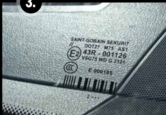
Oznakowanie szyby mikrobusu VW Crafter
