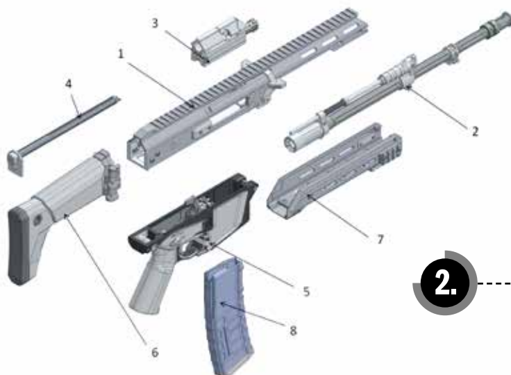
Rys. 2. Podstawowe zespoły karabinka standardowego MSBS-5,56K: 1 – komora zamkowa, 2 – lufa, 3 – suwadło z zamkiem, 4 – urządzenie powrotne, 5 – komora spustowa, 6 – kolba, 7 – łożo, 8 – magazynek
