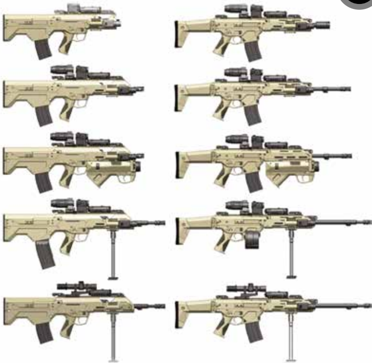
Rys. 1. Modułowy system broni strzeleckiej kalibru 5,56 mm (MSBS-5,56). Po lewej stronie – w układzie bezkolbowym (MSBS-5,56B), po prawej – w układzie klasycznym (MSBS-5,56K). Do obu podsystemów należą (od góry): subkarabinek, karabinek standardowy, karabinek-granatnik, karabinek maszynowy i karabinek wyborowy
