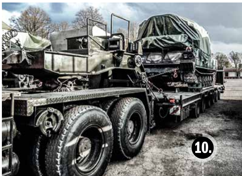
Zabezpieczenie ładunku na naczepie
