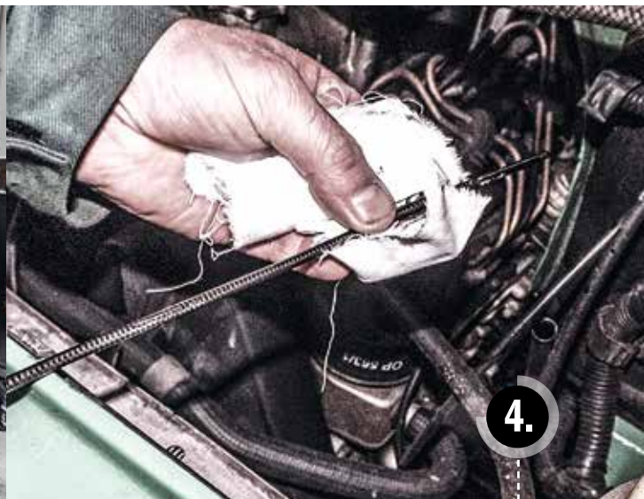
Kontrola poziomu oleju w silniku
