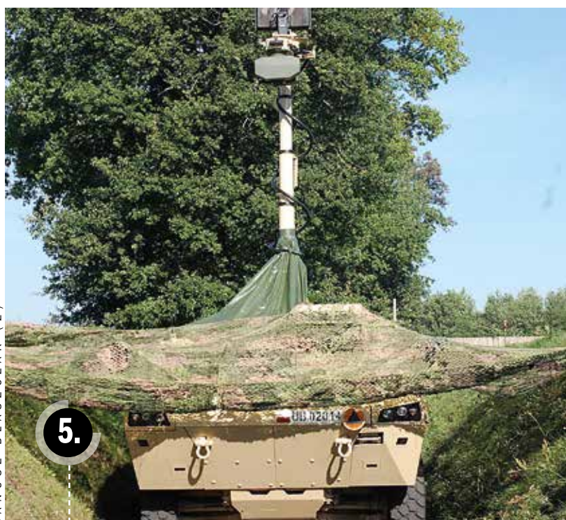
Wielosensorowy system rozpoznania i dozoru na KTO Rosomak
