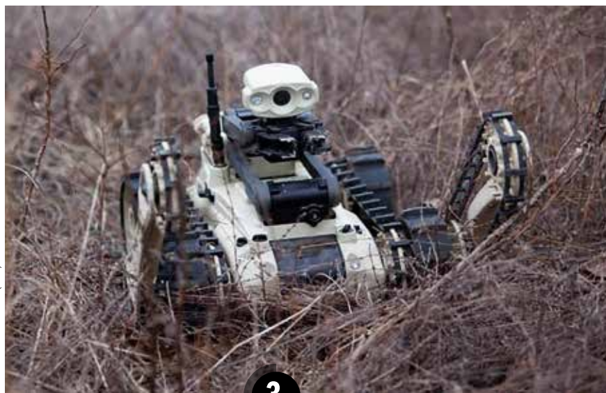
Lekki bezzałogowy pojazd rozpoznawczy Tarantula firmy Roboteam
