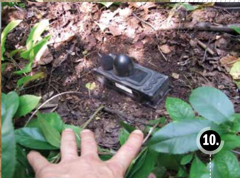
Jeden z dziewięciu sensorów akustyczno-sejsmicznych przesyła dane bezpośrednio do konsoli operatorskiej w WSRID.
