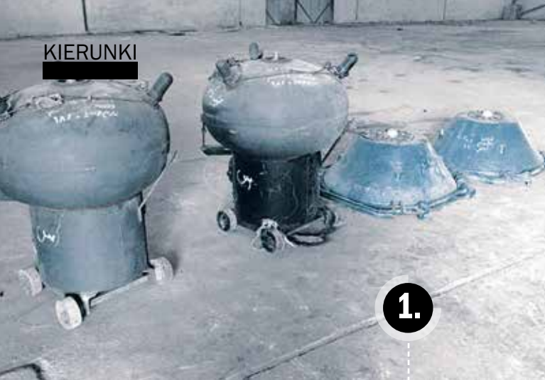
Miny morskie kotwiczne kontaktowe (LUGM-145) oraz denne niekontaktowe (Manta) z arsenału irackiego
