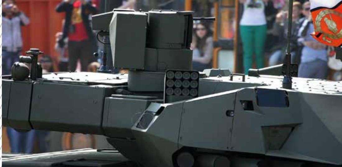
Na wieży czołgu T-14 zainstalowano sensory obserwacyjne oraz związane z systemami samoobrony pojazdu.
