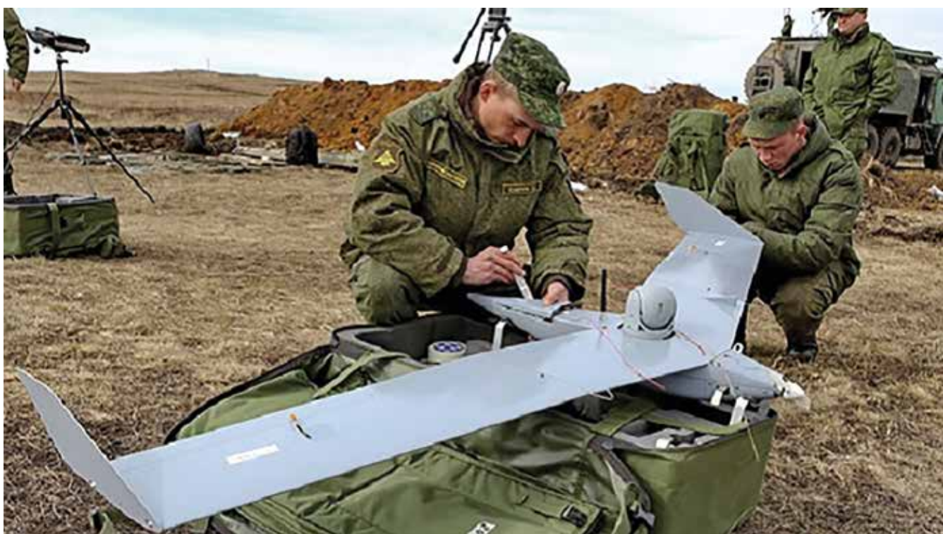
Fot. 1. Rosyjski BSP Zastawa wzorowany na izraelskim zestawie Bird Eye 400
