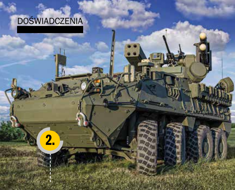
Rakietowo-artyleryjski system przeciwlotniczy IM-SHORAD na podwoziu kołowego wozu bojowego Stryker
