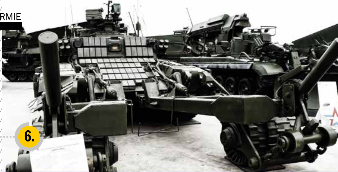
Robot Prohod-1 sterowany z mobilnego punktu dowodzenia umieszczonego na pojeździe Kamaz-63501
