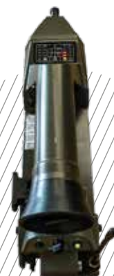
Symulator AP24C SimKit do wykrywania i rozpoznawania skażenia bojowymi środkami trującymi (po lewej). Przyrząd rozpoznania skażeń BST AP-2C (po prawej)
