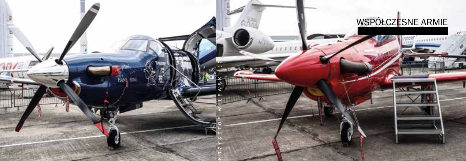
Szturmowo-obserwacyjny Archangel opracowany na bazie rolniczej maszyny Trush 710.
