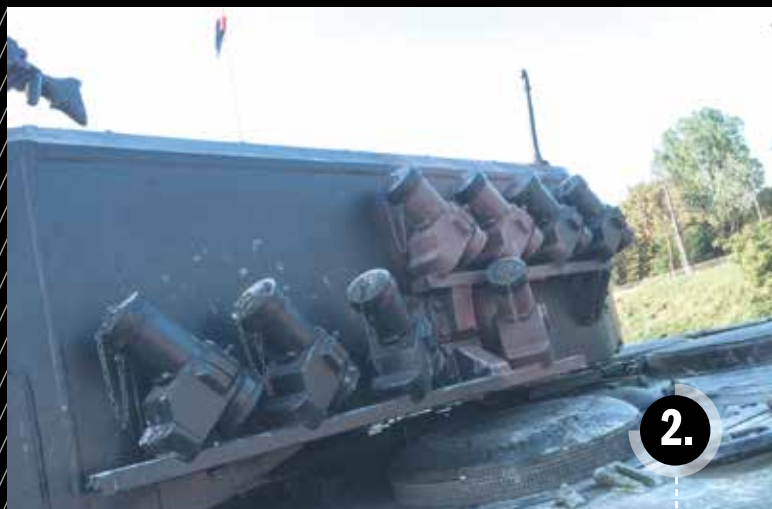
Wyrzutnia granatów dymnych kalibru 76 mm Krauss-Maffei Wegmann, umieszczona po lewej stronie wieży czołgu Leopard 2A4
