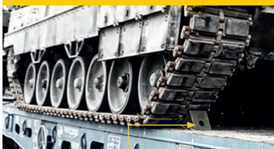
Klin zamocowany pod wewnętrzną częścią dwurolkowej gąsienicy Leoparda 2A4
