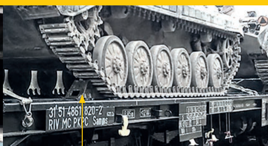
Przesunięty do wewnątrz klin ze względu na położoną w podłodze metalową kłonicę w wagonie Samms
