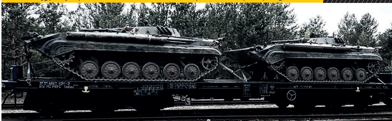
Przesunięcie pojazdów względem środka symetrii wagonu spowodowane metalowymi elementami (kłonicy, uchwyty mocujące) w podłodze wagonu
