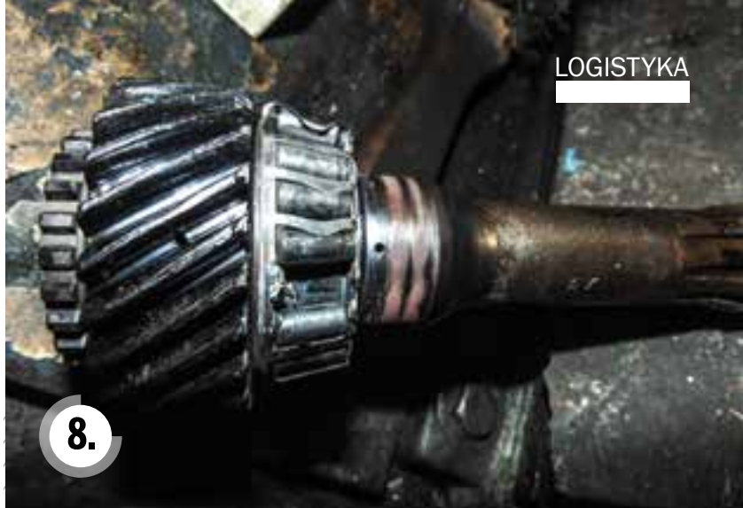
Uszkodzenia mechaniczno-termiczne łożyska
