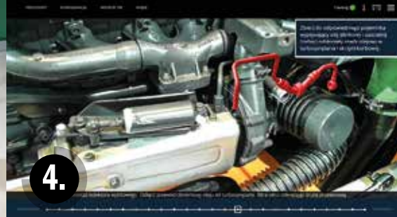
Widok uruchomionej procedury demontażu kolektora wylotowego silnika pojazdu Jelcz 442.32 z podziałem na operacje
