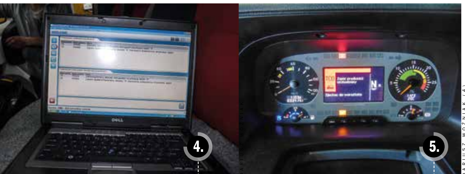
Odczyty i analiza niesprawności silnika pojazdu Fiat Ducato
