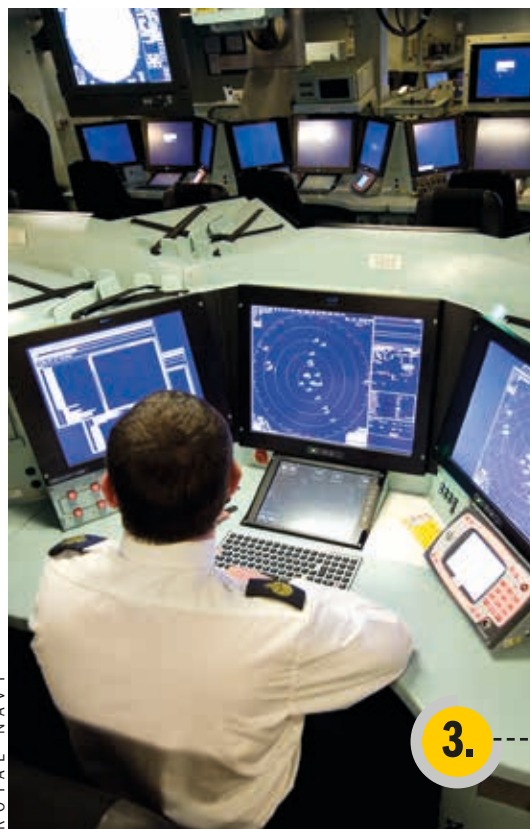
Fragment BCI, w tym wielofunkcyjne konsole operatorskie na jednym z brytyjskich niszczycieli obrony powietrznej typu 45/Daring
