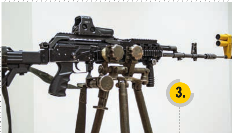
Zestaw UCEL 22 zamontowany na kbs Beryl kalibru 5,56 mm z celownikiem holograficznym HWS
