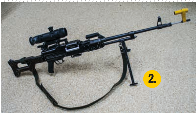
Zestaw UCEL 30/PK zamontowany na UKM 2000P kalibru 7,62 mm
