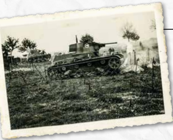
Czołg 7TP, zaprojektowany w Państwowych Zakładach Inżynieryjnych w oparciu o brytyjskiego Vickersa, był najlepszym pojazdem bojowym Wojska Polskiego w 1939 roku.
