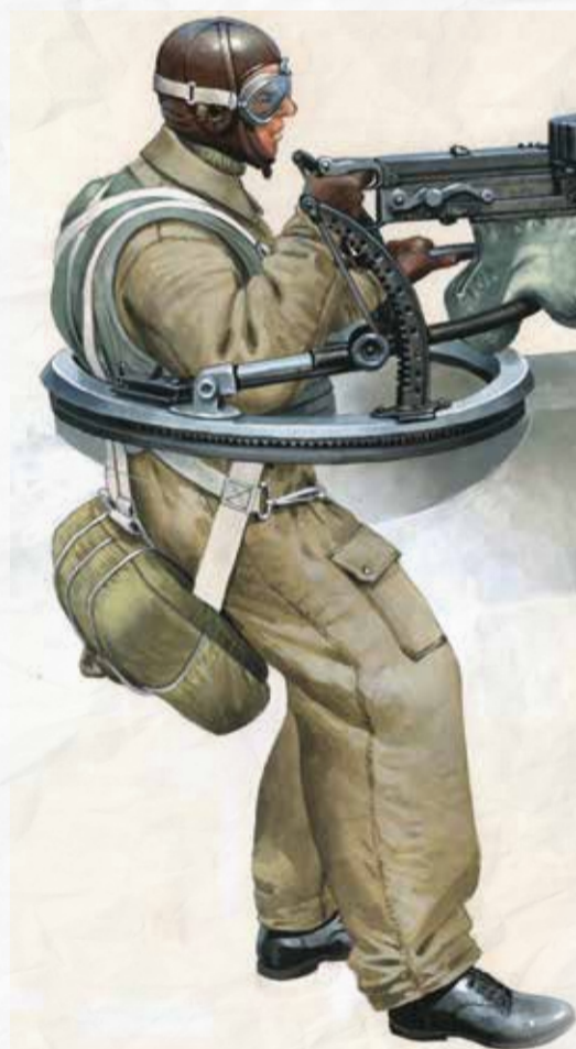
Obserwator samolotu Lublin R.VIII obsługujący karabin maszynowy Vickers F kal. 7,92 x 57 mm na obrotnicy T07, używający przyrządu celowniczego FK-38, złożonego z przeziernika i muszki wiatrowej. Karabiny te, zamówione przez Wojsko Polskie, wyprodukowano w Wielkiej Brytanii, fabrycznie dostosowując je do używanej w Polsce amunicji mauserowskiej. Broń zasilano z 95-nabojowych magazynków bębnowych. Obserwator w kombinezonie lotniczym wykonanym z materiału Inianego. Na głowie pilotka wykonana ze skóry. Okulary lotnicze wykonane ze szkła osadzonego w aluminiowych ramkach. Obserwator wyposażony jest w spadochron plecowy typu Polski Irvin produkowany w Wytwórni Balonów i Spadochronów w Legionowie. Na rękach rękawice skórzane na futrze.
