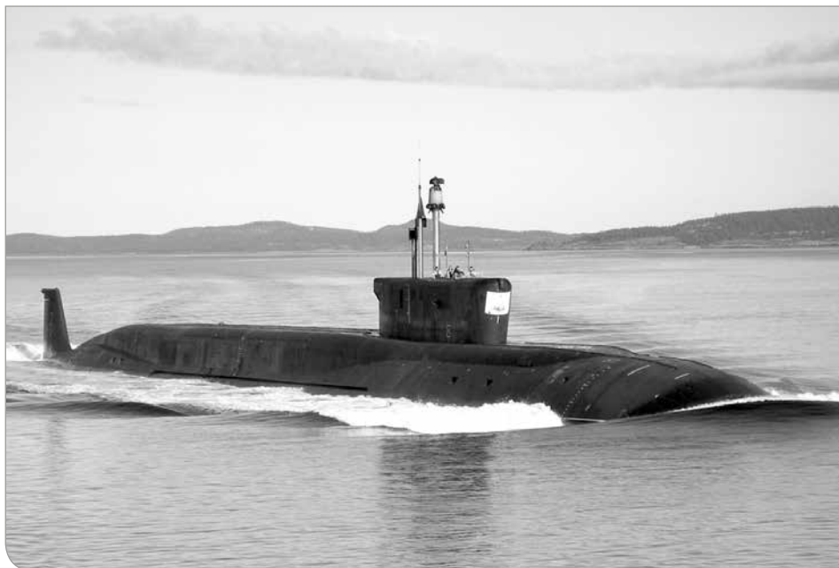
Rys. 2. Okręt podwodny projektu 955 typu Borej. Uzbrojony w 16 rakiet Buława, zawierających po 6 ładunków jądrowych o mocy 550 kt, o zasięgu do 10 000 km i dokładności trafienia w cel około 200 m. Głębokość testowa zanurzenia – 600 m, prędkość podwodna – 29 węzłów. Załoga – 130 osób. Może odpalić rakietę z zanurzenia do głębokości 50 m
