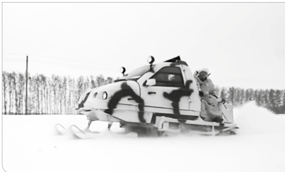
Skutery Bierkut z ogrzewaną kabiną
