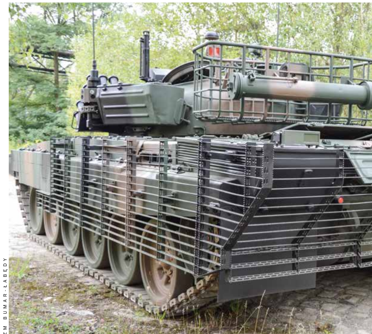
PT-91M2. Przedział silnikowy osłonięty pancerzem listwowym, z tyłu wieży kosz na wyposażenie załogi / PT-91M2. The engine protected with slate armor, at the back of the turret - compartment for crew equipment
