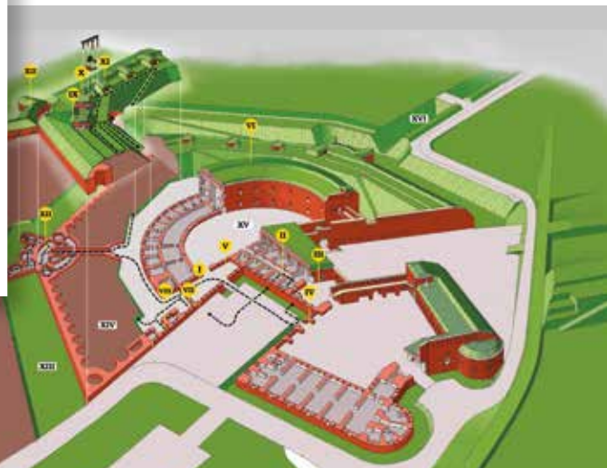
Widok perspektywiczny Bastionu III „Kleparz” w stanie z ok. 1887 r. wraz z ukazaniem jego struktury wewnętrznej. Na rysunku stanu historycznego naniesiono realizowaną ścieżkę zwiedzania. Rys. Wojciech Rymsza-Mazur, Arkadiusz Sordyl, Izabela Krzyszkowska, Krzysztof Wielgus, „Fundacja Polish Heritage”
