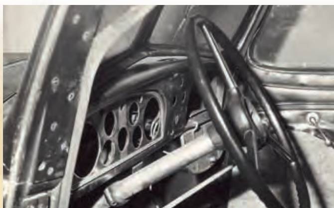
Zdewastowane wnętrze przedziału kierowcy. Zdekompletowana deska rozdzielcza, bez wskaźników i oprzyrządowania, wyrywana pokrywa schowka i kierownica z wymontowanym przyciskiem sygnału dźwiękowego. Dobrze widoczne uszkodzenia szyb i zniszczone obicie prawych drzwi przednich.
