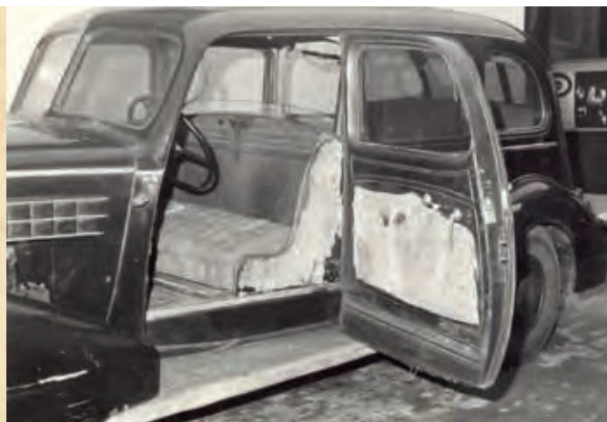
Lata osiemdziesiąte XX w., Cadillac 355D Series 30 Fleetwood 7 Passengers Limousine. Zniszczone obicie drzwi przednich i brak skórzanych siedzeń w przedziale kierowcy. Widoczne zastępcze siedzisko – materac z obiciem tapicerskim. Fot. Zbiory Jana Tarczyńskiego
