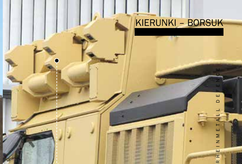
Fot. 2. Lekka wersja systemu AMAP-ADS. Od wersji ciężkiej różni się typem efektorów oraz zastosowanych radarowych efektorów
