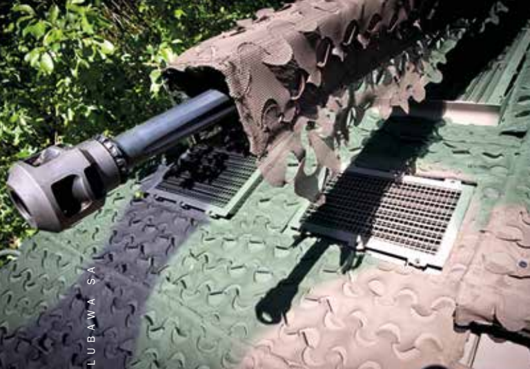
Kamuflaż mobilny (3D) zastosowany na KTO Rosomak (na pierwszym planie ekran termalny – osłona lufy)
