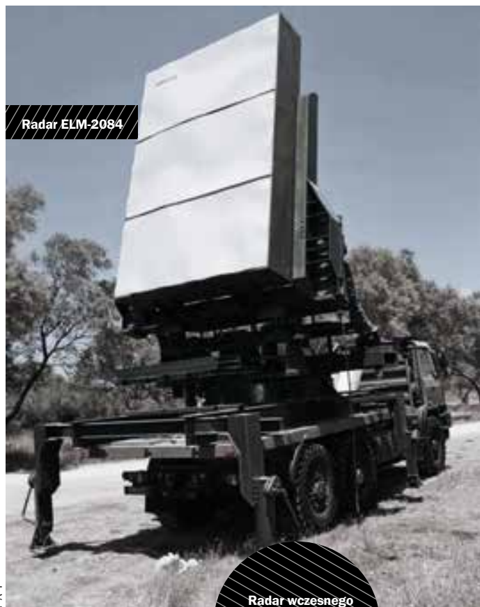
Radar wczesnego wykrywania (SR) zestawu MEADS z anteną AESA
