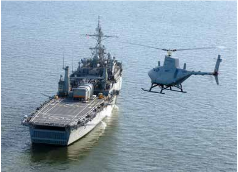
Platforma MQ-8B podczas autonomicznego podejścia do lądowania na pokładzie okrętu
