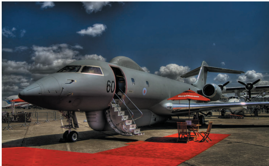
Fot. 5. Brytyjska załogowa platforma powietrzna systemu ASTOR bazuje na kanadyjskim samolocie typu bussines jet Global Express
