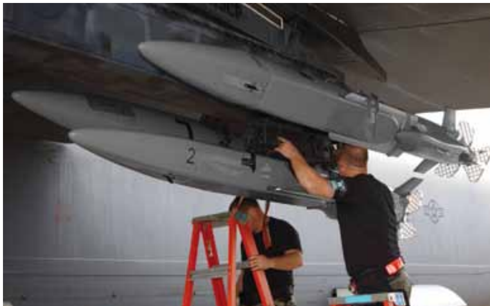
FOT. 2. ELEKTRONICZNE PUŁAPKI POWIETRZNE zakłócające MALD-J podczipione do węzła uzbrojenia samolotu
