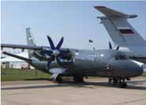
FOT. 3. LEKKI SAMOŁOT TRANSPORTOWY AN-140-100. Zwraca uwagę brak rampy ładunkowej
