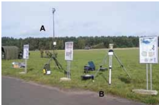
Fot. 3. Mobilna stacja meteorologiczna AGAT-20L (A) oraz teodolit do pomiarów wiatrów górnych TEBAL (B) w trakcie ćwiczeń „Orzeł-11”
