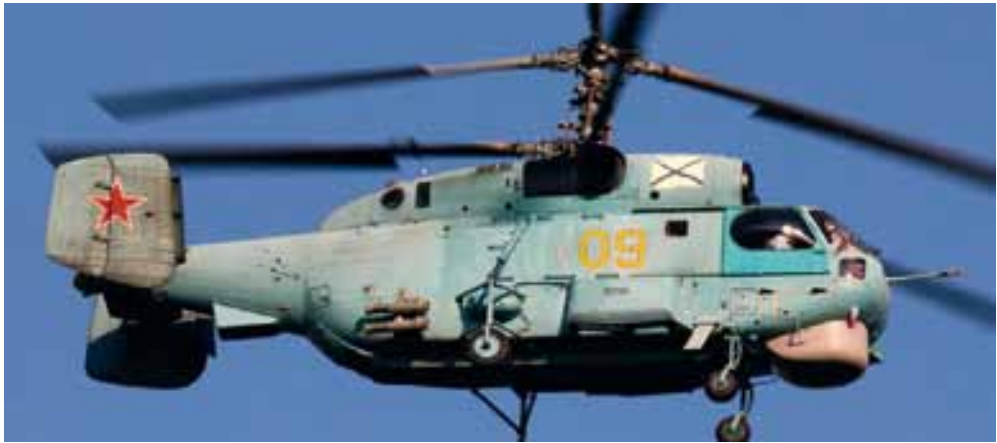
FOT. 5. ŚMIGŁOWIEC K-27 do zwalczania okrętów podwodnych
