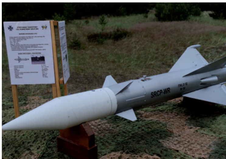
FOT. 2. EFEKTEM REALIZACJI ZADAŃ badawczo-rozwojowych przez Instytut Techniczny Wojsk Lotniczych jest m.in. imitator celu powietrznego SRCP-WR
